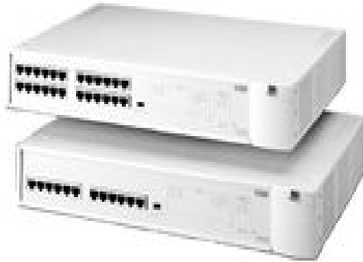
Gambar 6. 1 Bentuk hub dan switch
